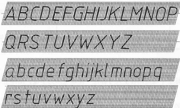
图 1—11 B 型斜体拉丁字母示例
